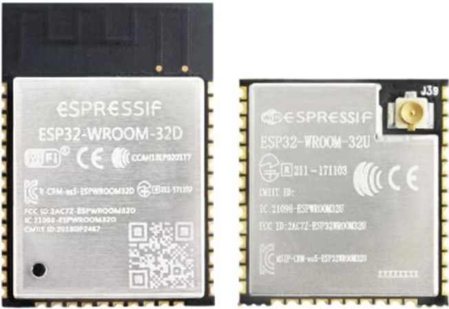
Srovnání modulů s anténou MIFA (vlevo) a s konektorem U.FL (vpravo)
