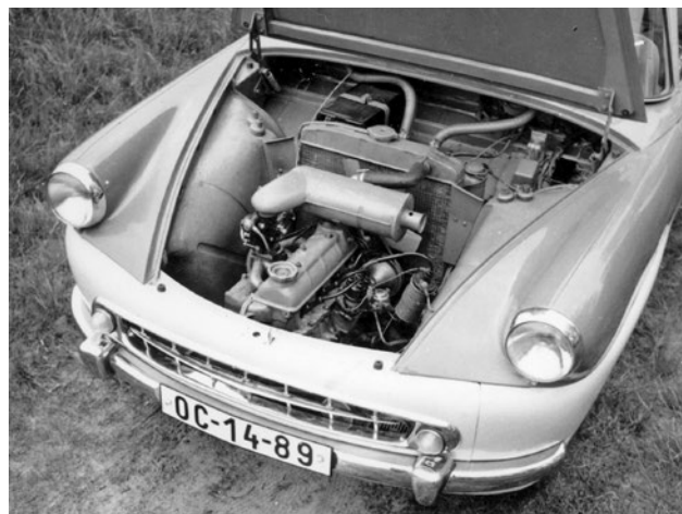
Š 976 s řadovým čtyřválcem před přední nápravou a chladičem za motorem
