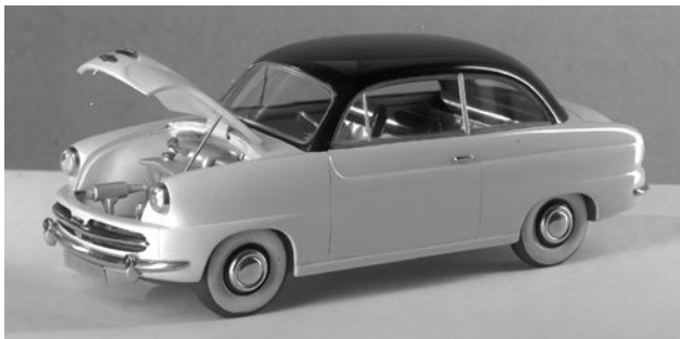
Start 900 měl mít podle návrhu Ing. Rudolfa Vykoukala chladič za motorem
