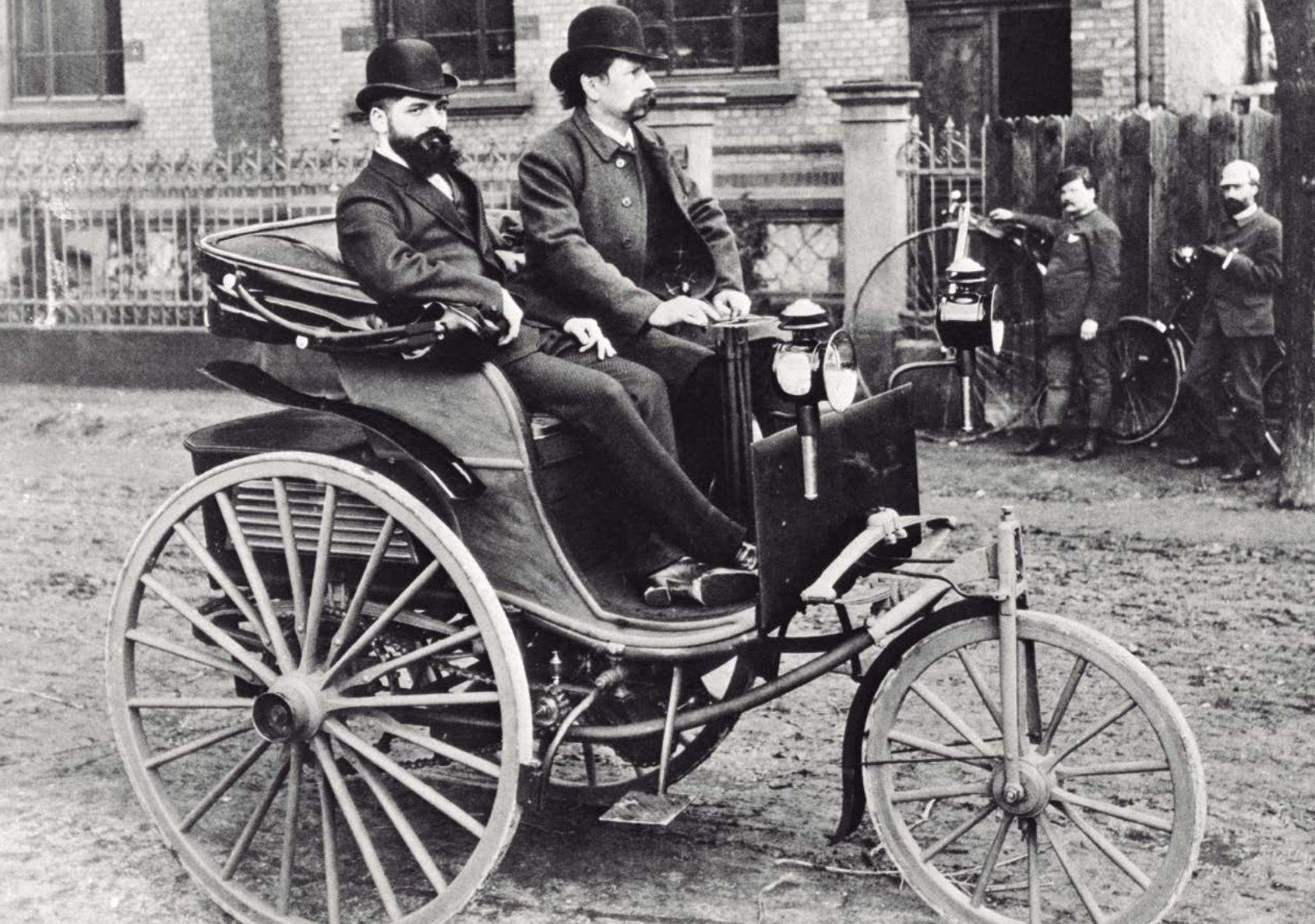
Model 3; 1,5 koní, 1886–1894. Ve vozidle Josef Brecht, za volantem Carl Benz. Typ III měl dřevěná kola, která byla mnohem odolnější při špatných podmínkách na silnici
