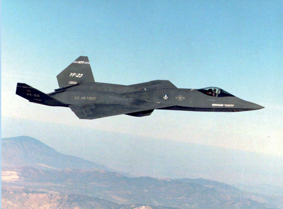
První prototyp konkurenčního YF-23. Letoun je dokonalým příkladem sesouhlasení úhlu všech hran vůči podélné rovině trupu. Jeho „stealth“ vlastnosti byly hodnoceny jako excelentní.
