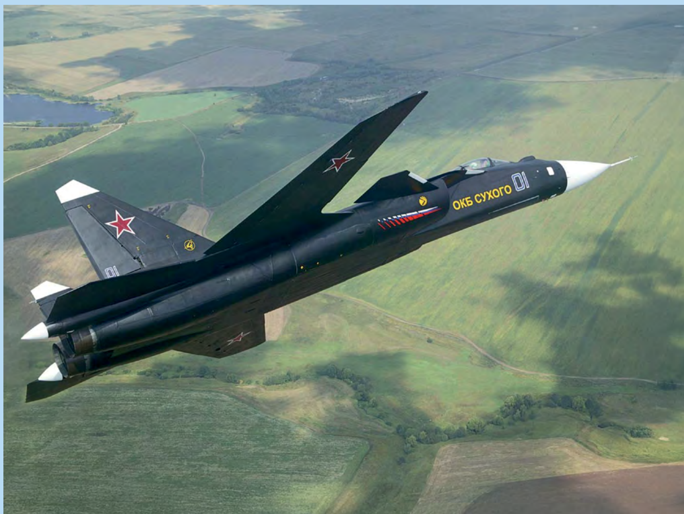
Demonstrátor stroje nové generace Suchoj Su-47 Berkut s křídlem o negativní šípovitosti. Jeho aerodynamické výkony sice byly výtečné, méně výhodné ale bylo kvůli zástavbě paliva a elektroniky.
