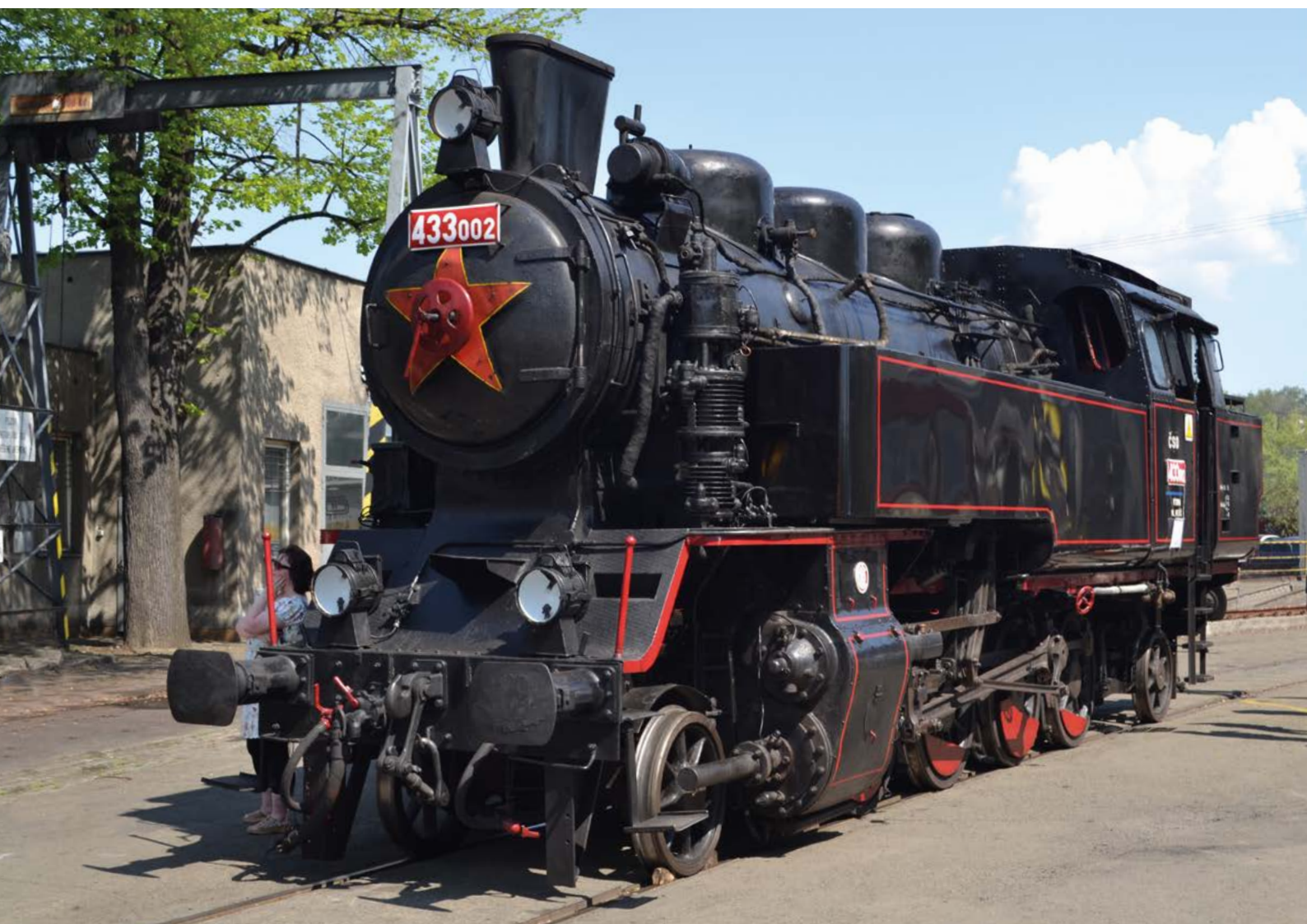
U ČSD bylo použití dyšny Giesel značně rozšířeno. Lokomotivy vybavené tímto zařízením jsou lehce rozpoznatelné díky charakteristickému plochému tvaru komína.
