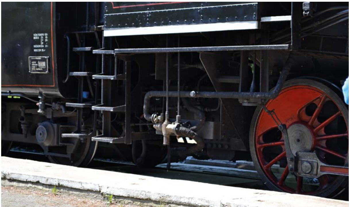
Na fotografii je nasací parní injektor. Většina parních lokomotiv ČSD měla dvě tyto armatury, po jedné na každé straně. Traťové lokomotivy měly vlevo nasací napáječ na výfukovou páru.
