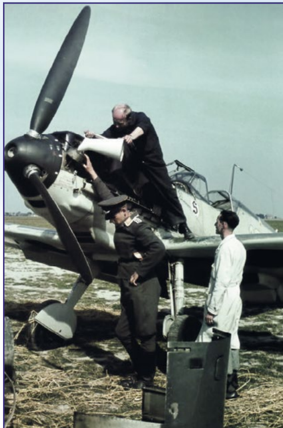
Pozemní personál pracující na motoru Daimler-Benz DB 601 umístěném v předí Messerschmittu Bf 109 E
