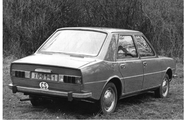
Zadní čelo karoserie Š 727 neslo vodorovné obdélníkové sdružené svítelníky
