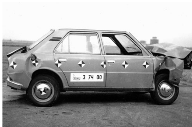
Testy prokázaly schopnost přední i zadní deformační zóny pohltit energii nárazu
