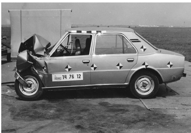
V květnu 1976 absolvoval jeden z prototypů Š 742 čelní bariérovou zkoušku
