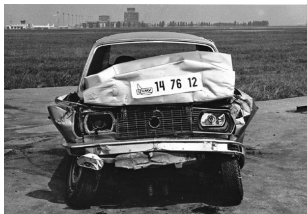
Před karoserie byla nárazem zničena, prostor pro cestující jej přestál bez úhony
