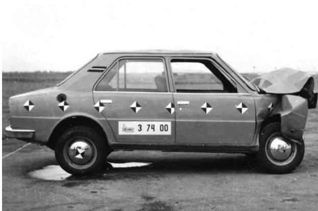
Na podzim 1974 provedl pražský ÚVMV nárazové zkoušky karoserie Š 742
