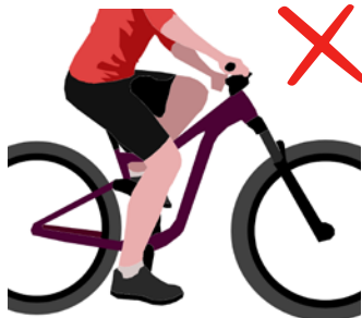
Špatně nastavená výška sedla – noha je příliš pokrčená.
