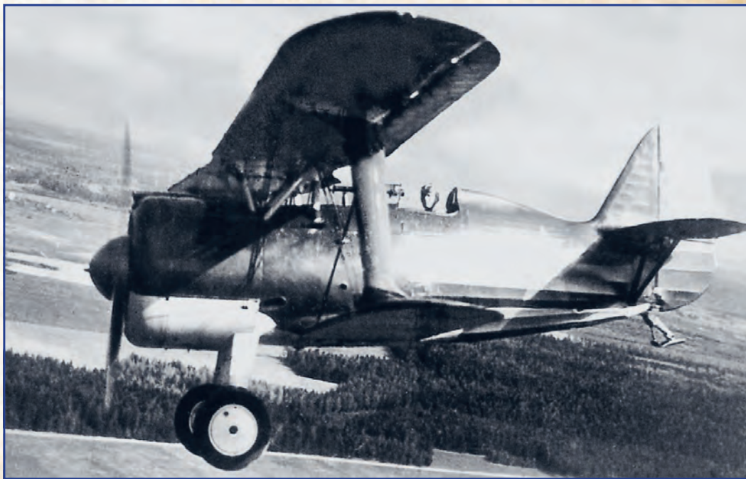
Předchůdce čajky Polikarpov I-15bis s charakteristickým průběžným horním křídlem
