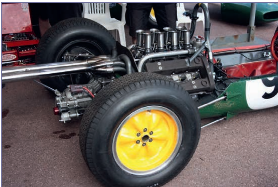
Motor Coventry-Climax v zádi Clarkova Lotusu Mk25
