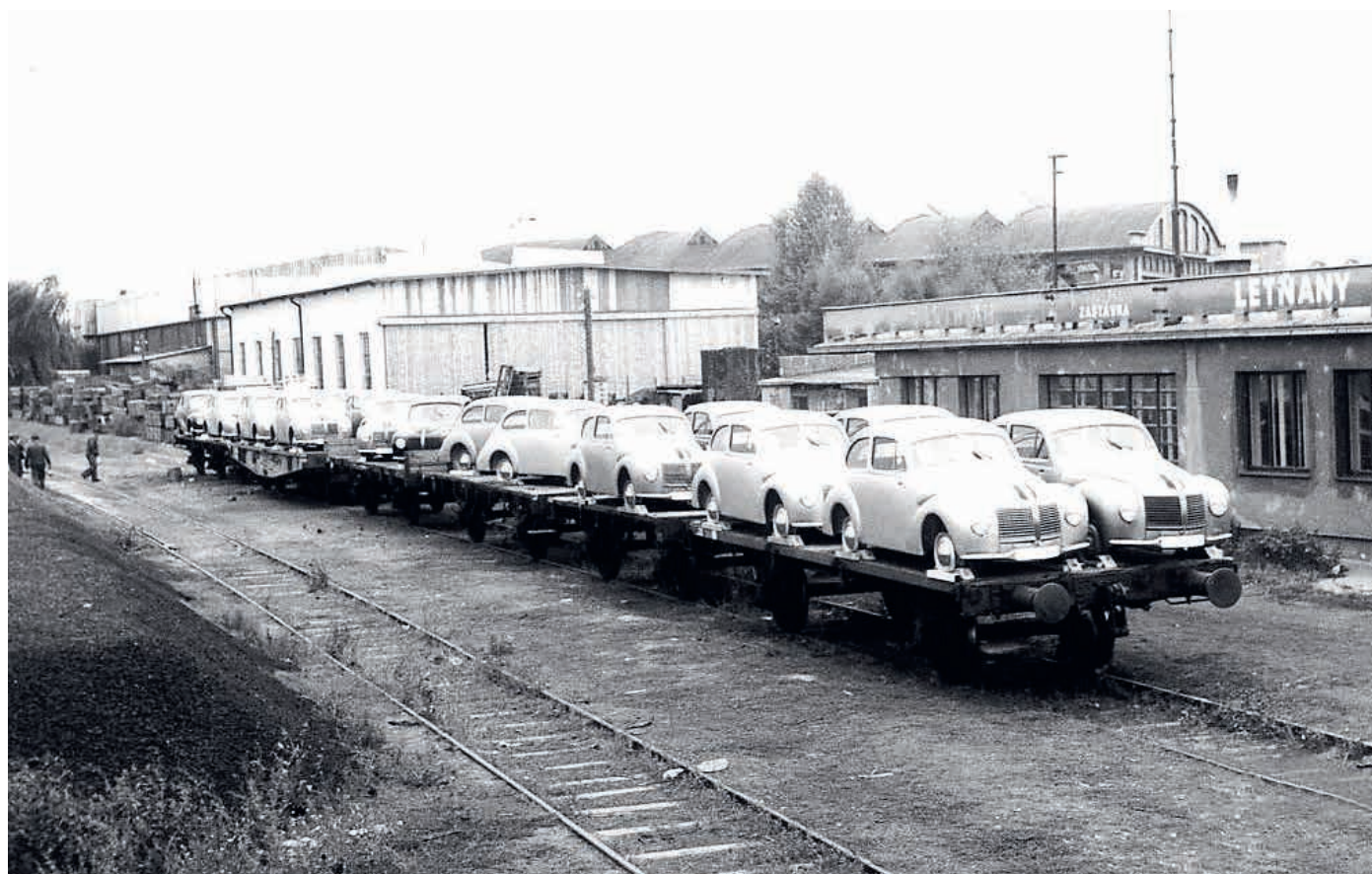
Zastávka Letňany v areálu firmy Letov. K expedici jsou na konci čtyřicátých let připraveny zcela nové automobily Jawa Minor. Zvláštností je jejich naložení ve dvou řadách na velmi krátké plošinové vozy, jejichž malá délka umožňovala zvětšit jejich šířku, sbírka Radim Šnábl.
