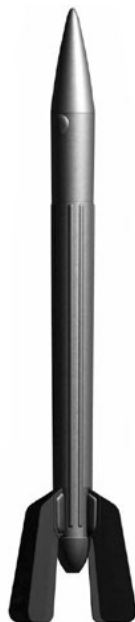
GIRD-09 , model první sovětské rakety, která úspěšně odstartovala
