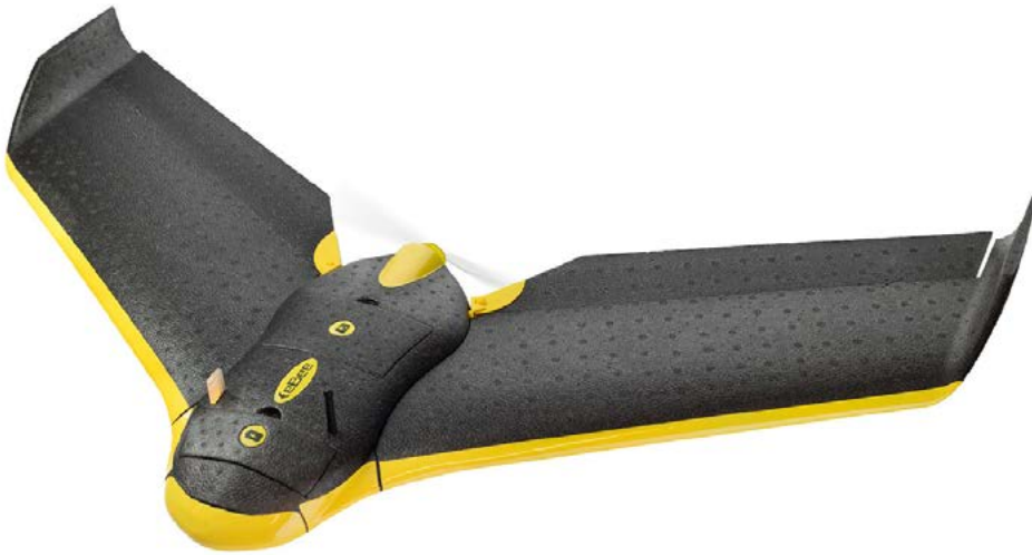
Obrázek 3.2 Bezpilotní mapovací letoun SenseFly eBee
