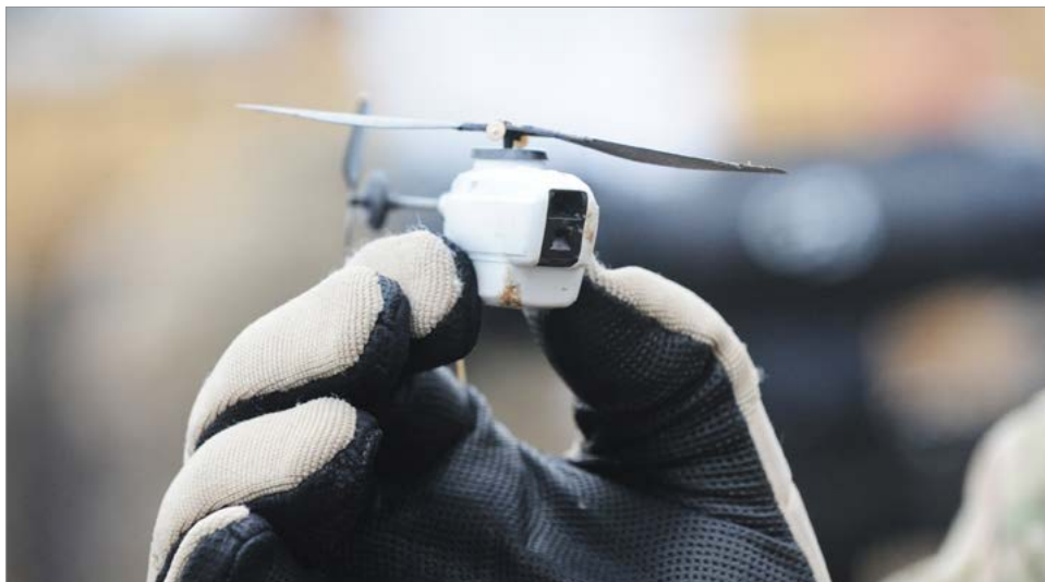
Obrázek 2.3 Nanodron Black Hornet – průzkumný miniaturní dron převážně do interiérů
