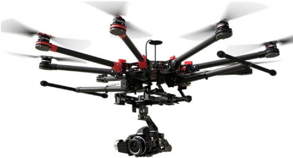
Obrázek 3.7 Oktokoptéra DJI S1000 se sklápěcíma nohama a tříosým stabilizovaným kamerovým závěsem
