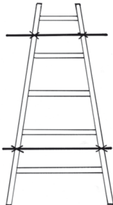
Svislý provizorní rám ze štaflí
